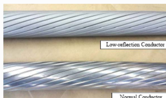
Рис.11. Матовые провода с низкой отражающей способностью (вверху рис.)
